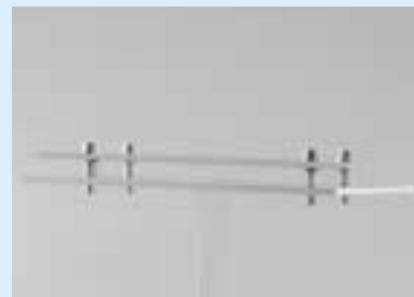
シャーシーにPC板を取付けた場合
